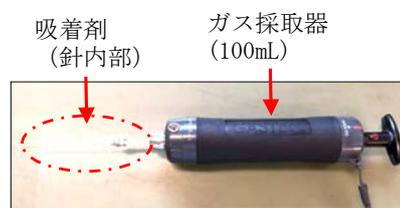
図 4 ガス採取器と吸着剤の外観
